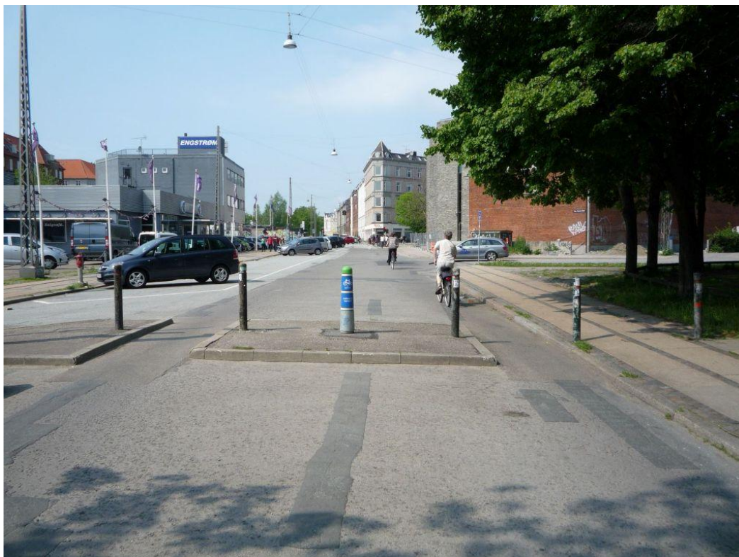
Fot. 16 Ulica bez wylotu z zapewnieniem przejazdu rowerem. /Michał Rejczak/
