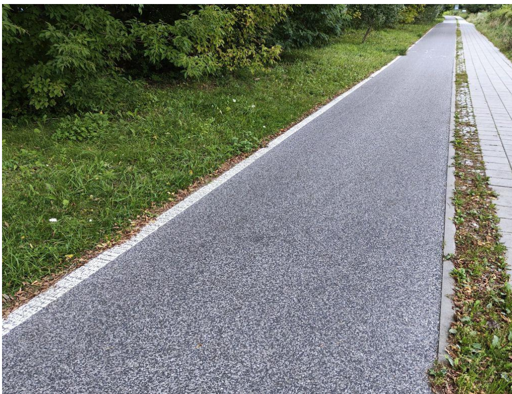
Fot. 36 Przykład zastosowania linii krawężniowej na odcinku nieoświetlonym. /Michał Rejczak/
