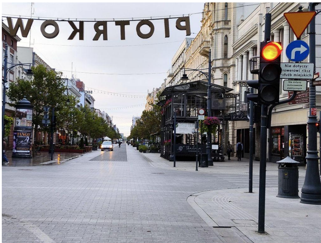
Fot. 14 Przykład rozcięcia tranzytu oznakowaniem – rowery mogą na wprost, pozostałe pojazdy tylko w prawo. /Michał Rejczak/
