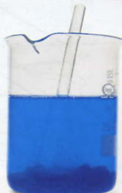
Fot. 53. Przygotowany roztwór siarczanu(VI) miedzi(II) jest roztworem nasyconym, gdyż dodane do niego kryształki siarczanu(VI) miedzi(II) nie rozpuszczają się
